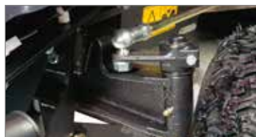
Assale anteriore ricavato da una fusione in acciaio per resistere anche alle applicazioni più estreme e ad eventuali urti.
