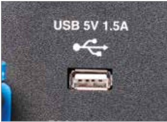
Uscita con presa USB per alimentare direttamente apparecchiature elettroniche.
