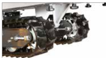
Larghi cingoli che garantiscono una perfetta aderenza su ogni tipo di terreno (sicurezza per l'operatore).
