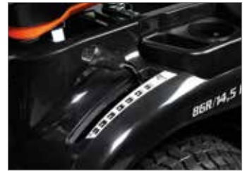
Regolazione altezza di taglio tramite pratica leva posta a portata di mano con scala graduata che consente un'immediata visualizzazione del livello di altezza di taglio desiderato.
