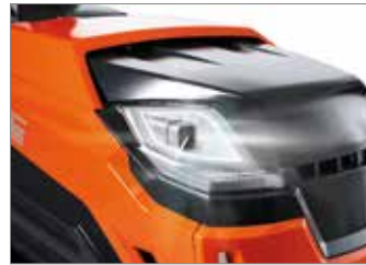
Fari a LED con funzione luce diurna garantiscono alta visibilità anche in condizioni di scarsa luminosità.
