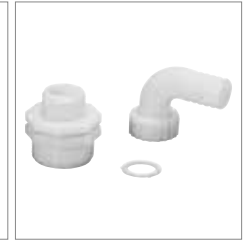
Kit raccordo opz. curvo con riduzione da 1" ½ a 1" (di serie su SA 30 TLA ).
