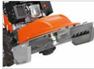
Piatto di taglio con apertura frontale per favorire l'ingresso a sterpaglie ed alta vegetazione (DEB 529).
