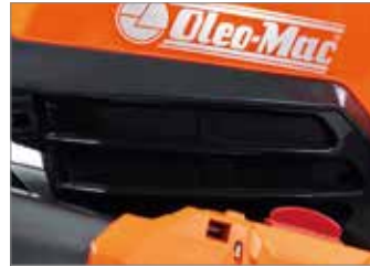
Ventola dedicata al raffreddamento del motore: attiva dall'accensione della macchina, permette al motore di lavorare in condizioni ottimali anche in presenza di elevate temperature ambientali.
