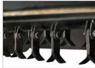
Rotore con coltelli a 'Y', potenti e resistenti, per tritare erba e sarmenti con piena efficienza senza timore di urti e danneggiamenti.
