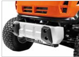
Ampio paraurti frontale in acciaio che garantisce robustezza e solidità in caso di urti accidentali.
